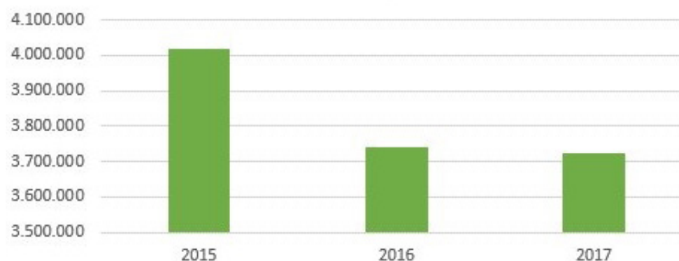
Abbildung 10: Wärmeverbrauch witterungsbereinigt in kWh (AAU gesamt) Quelle: Monatsabrechnungen und/oder Schätzung (Robert-Musil-Haus)
